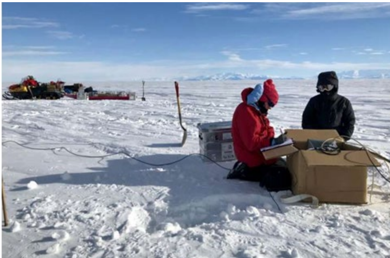
研究人员正在安装地球物理勘探仪器,测量南极洲西部惠兰斯湖冰流下方的地下水。
