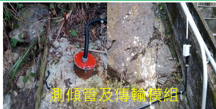
左壩座測傾管自動監測傳輸
