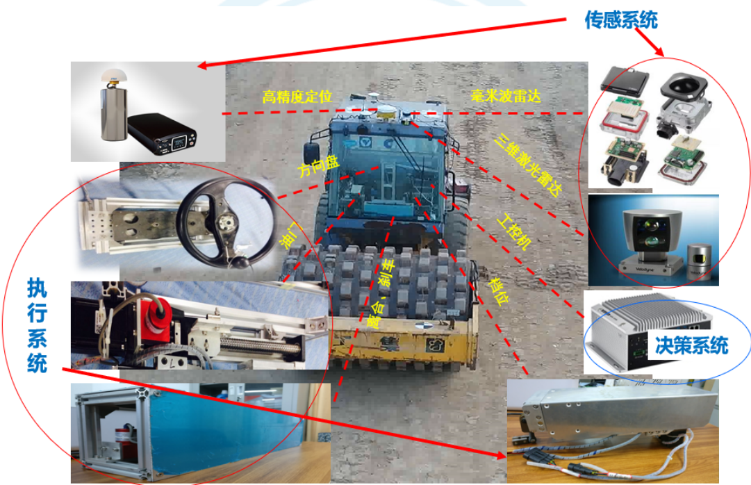
基于填筑施工机械无人驾驶技术的大坝智能化填筑碾压系统
