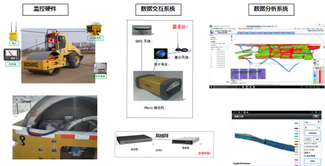
大坝填筑施工过程智能化监控系统
