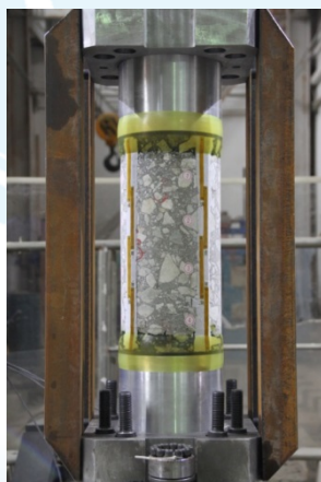
图2 沙牌大坝混凝土芯样动态性能试验
